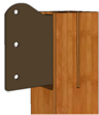
(e) 3개의 연결볼트를 이용한 기둥과 대들보의 철물접합
