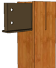
(c) 2개의 연결볼트와 받침재를 이용한 기둥과 도리의 철물접합
