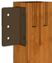
(b) 3개의 연결볼트를 이용한 기둥과 도리의 철물접합
