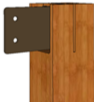
(c) 2개의 연결볼트와 받침재를 이용한 기둥과 도리의 철물접합
